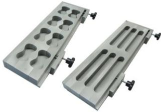
3 – Para processos de areia-resina soprados em cold box ou hot box podem ser utilizados os seguintes modelo:
