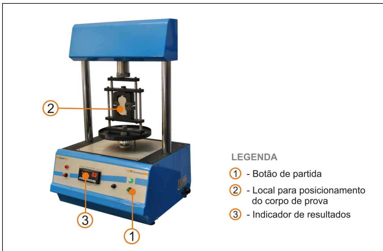
Figura 2 – Foto ilustrativa de uma máquina universal de ensaios montada com o acessório de resistência à tração.
