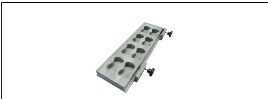
Figura 1 – Foto ilustrativa da caixa de macho para corpo de prova estrangulado.
