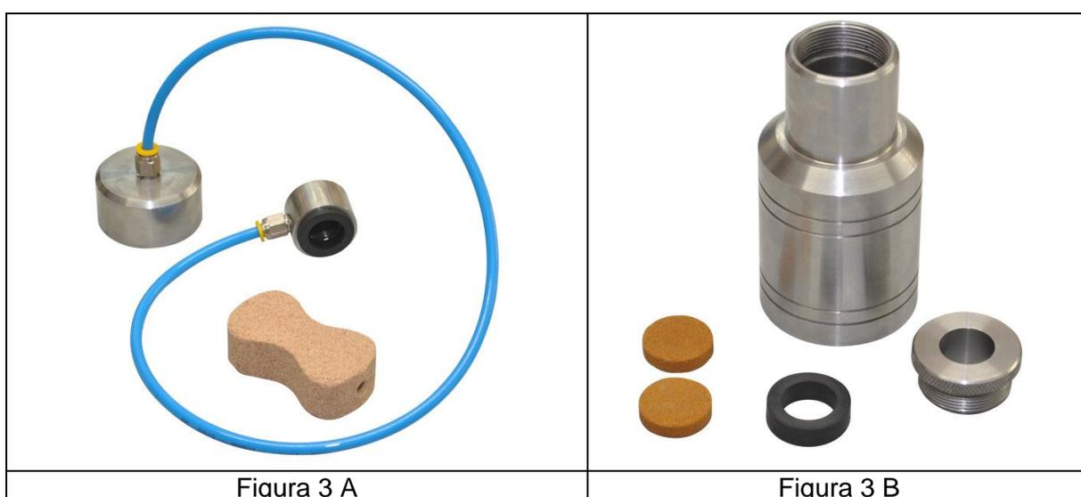
**Figura 3 – Fotos ilustrativas de acessório para ensaio de permeabilidade em areia coberta**
