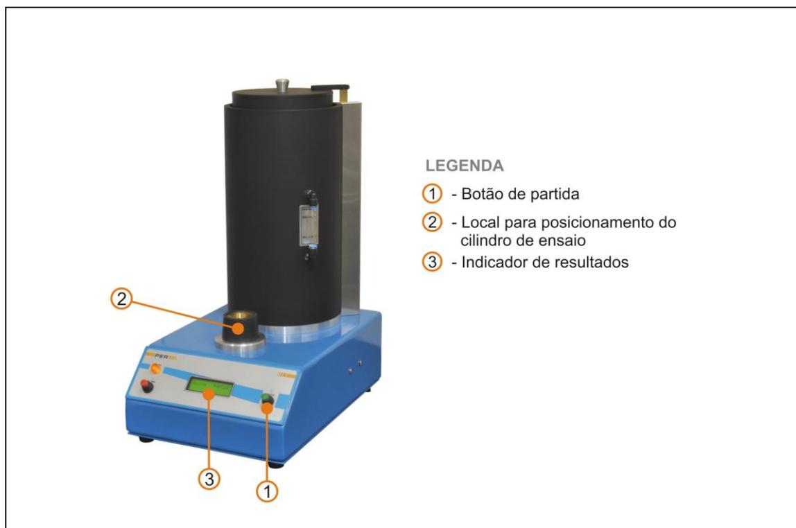
**Figura 1 – Foto ilustrativa de um permeâmetro.**
