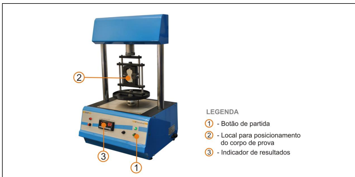
Figura 2 – Foto ilustrativa de uma máquina de ensaios para ensaio de resistência à tração.
