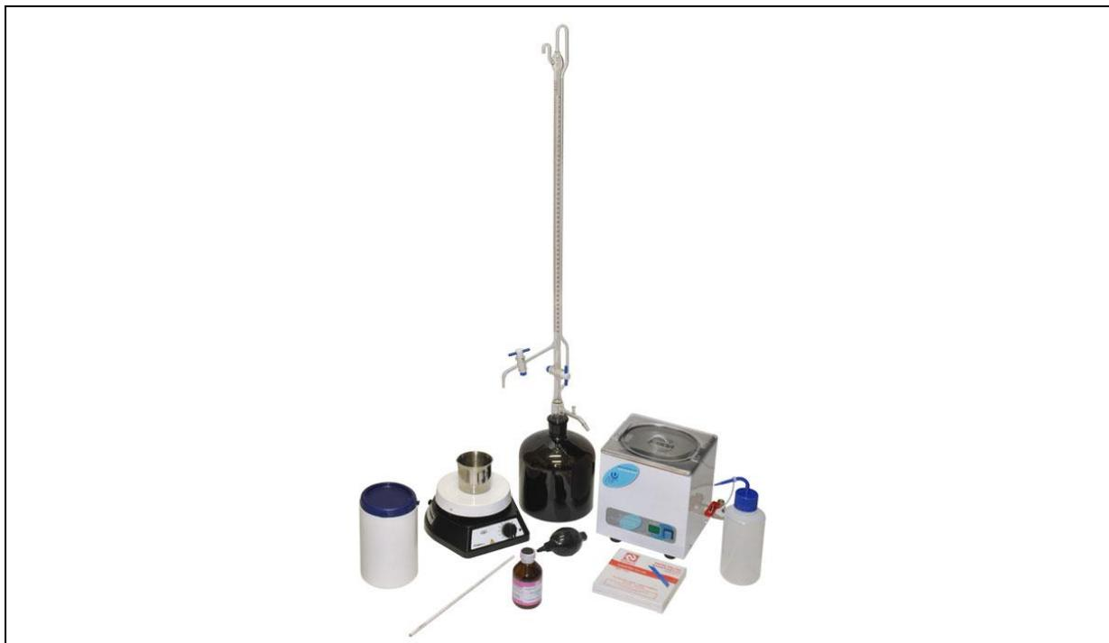
Figura 1 – Imagem ilustrativa de um kit para determinação do azul de metileno
