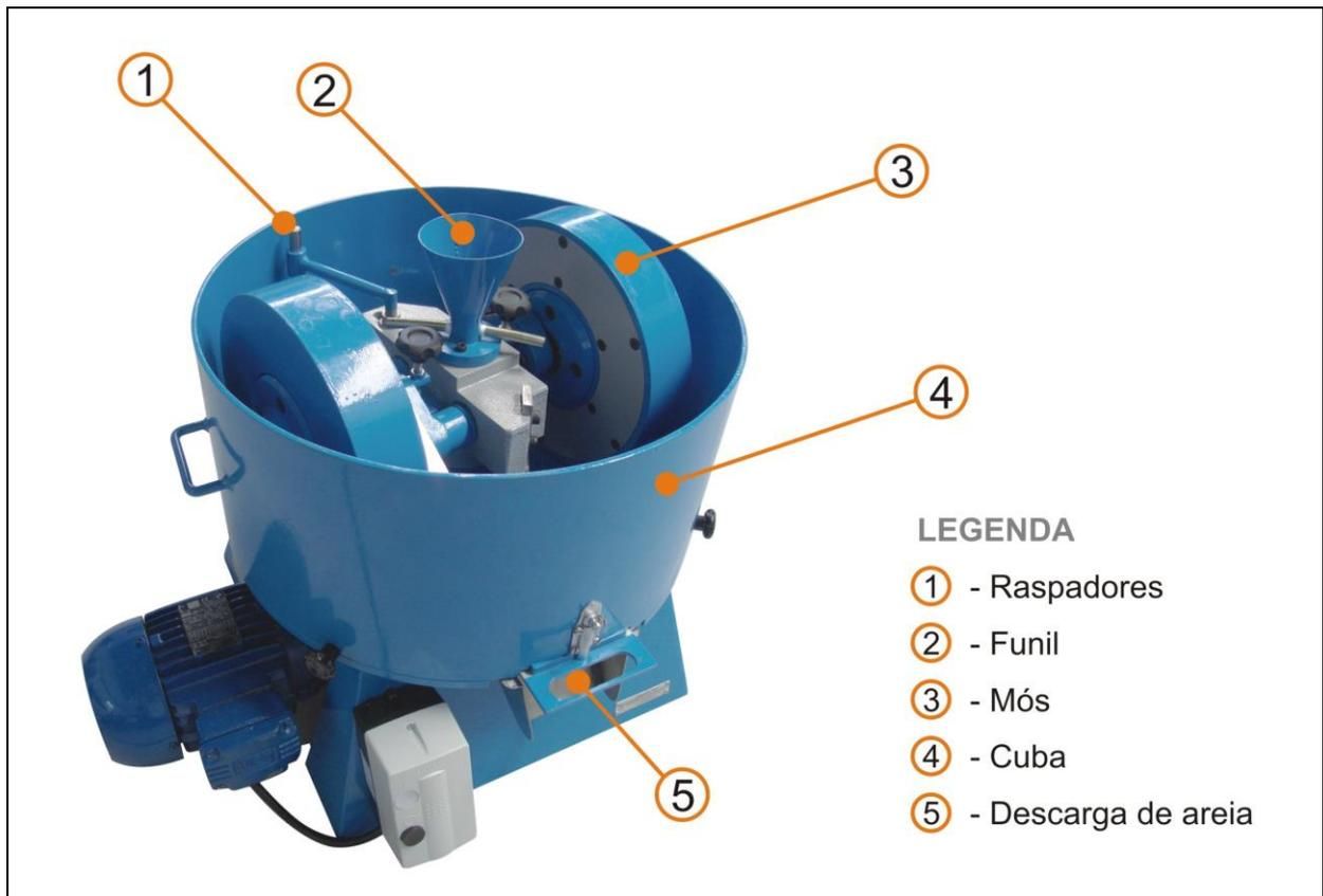
Figura 1 – Foto ilustrativa de um misturador de laboratório.
