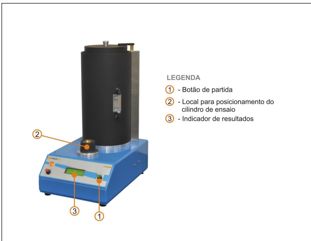
Figura 1 – Figura ilustrativa de um permeâmetro para areias de moldagem.
