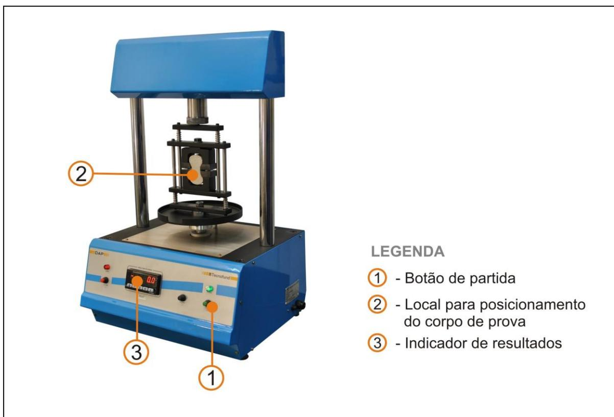
Figura 1 – Foto ilustrativa de uma máquina de resistência à tração a quente para areia coberta.
