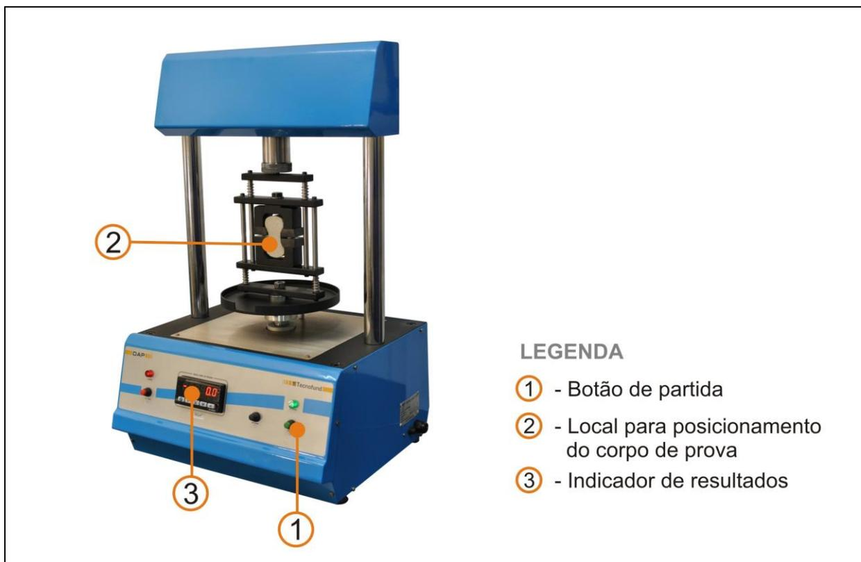
Figura 2 – Foto ilustrativa de uma máquina de ensaios para ensaio de resistência à tração.
