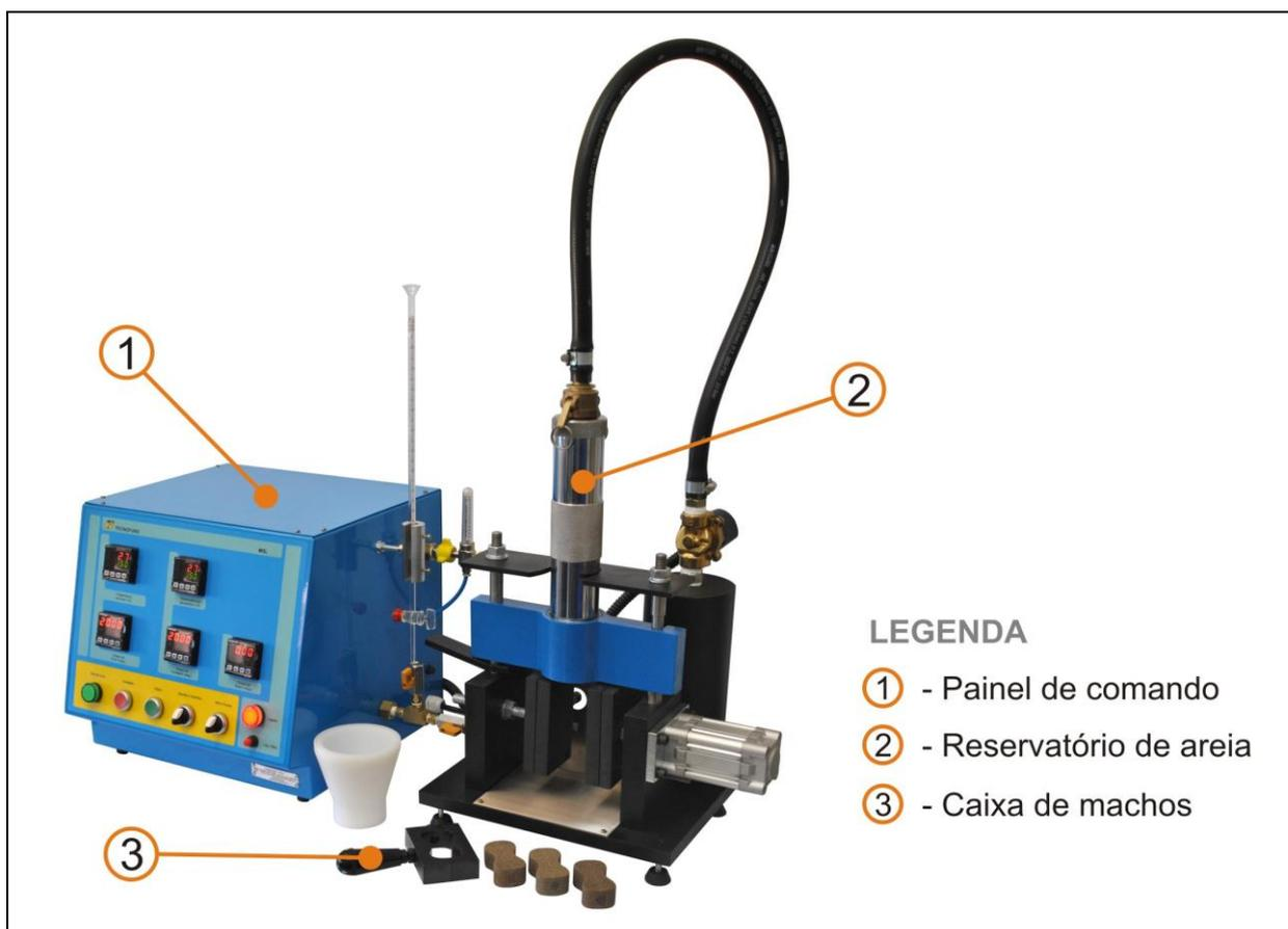
Figura 1 – Foto ilustrativa de uma sopradora de laboratório e suas partes principais.
