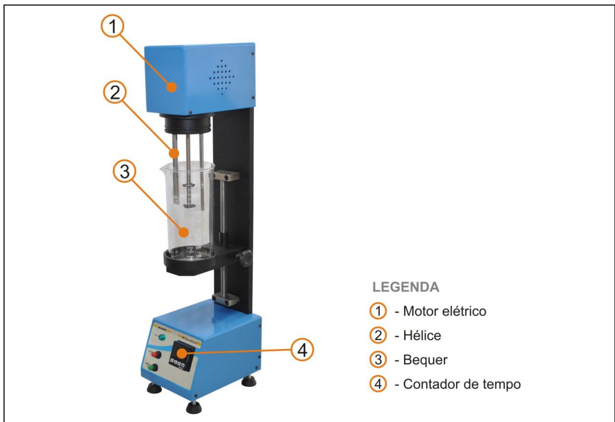
Figura 2 – Foto ilustrativa de um agitador mecânico de 7500 RPM
