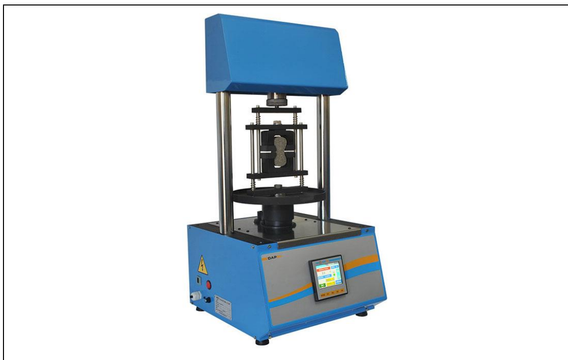
Figura 3 – Foto ilustrativa de uma máquina de ensaios para ensaio de resistência à tração.
