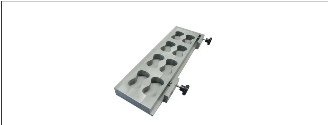
Figura 1 – Foto ilustrativa da caixa de macho para corpo de prova estrangulado.
